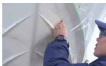
「マリングライド™」は透明な粘着フィルム。簡単に船底に貼ることができます。
