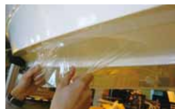
「マリングライド™」は透明な粘着フィルム。簡単に船底に貼ることができます。
