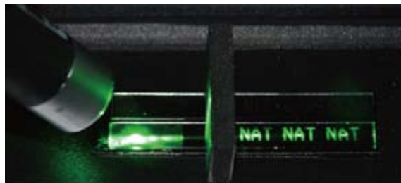
光導波路イメージ 画面の左側から入射した光は中央の壁の下に設けられた導波路（高分子を精密加工することによって形成された光の通路）を通って右側に到達し、光の文字を浮かび上がらせています。
