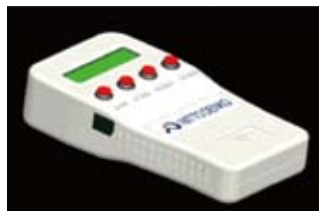
センサーデバイスイメージ この携帯サイズのデバイスに検体を入れるだけで、瞬時に数値化された生体情報を取得できます。
