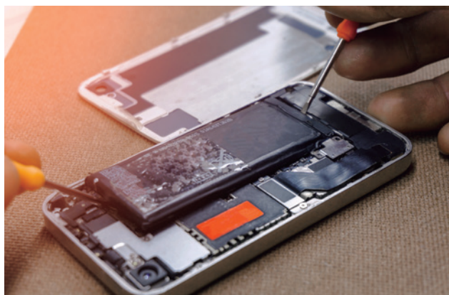
携帯電話のバッテリー固定に使用され、電気を流すことで簡単にバッテリー交換が可能
