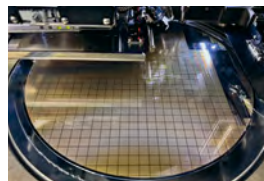
薄膜チップを薬品処理し、ピックアップできるダイシングテープ
