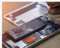
バッテリー固定用 電気剥離テープ
